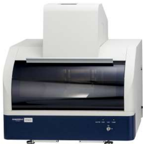
株式会社日立 High-Tech Science EA6000VX 图 4.4 能够进行元素映射的 X 射线荧光仪
