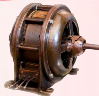
5馬力誘導電動機
