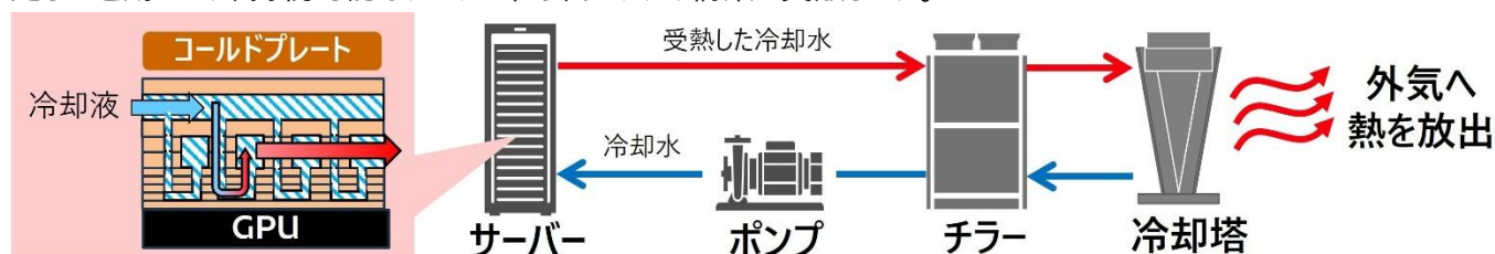
図 1 AI データセンターにおける冷却全体像(イメージ)
