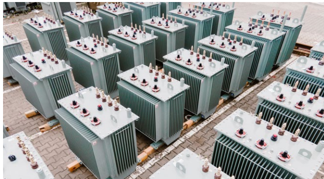
リサイクル鉱物油入り変圧器
