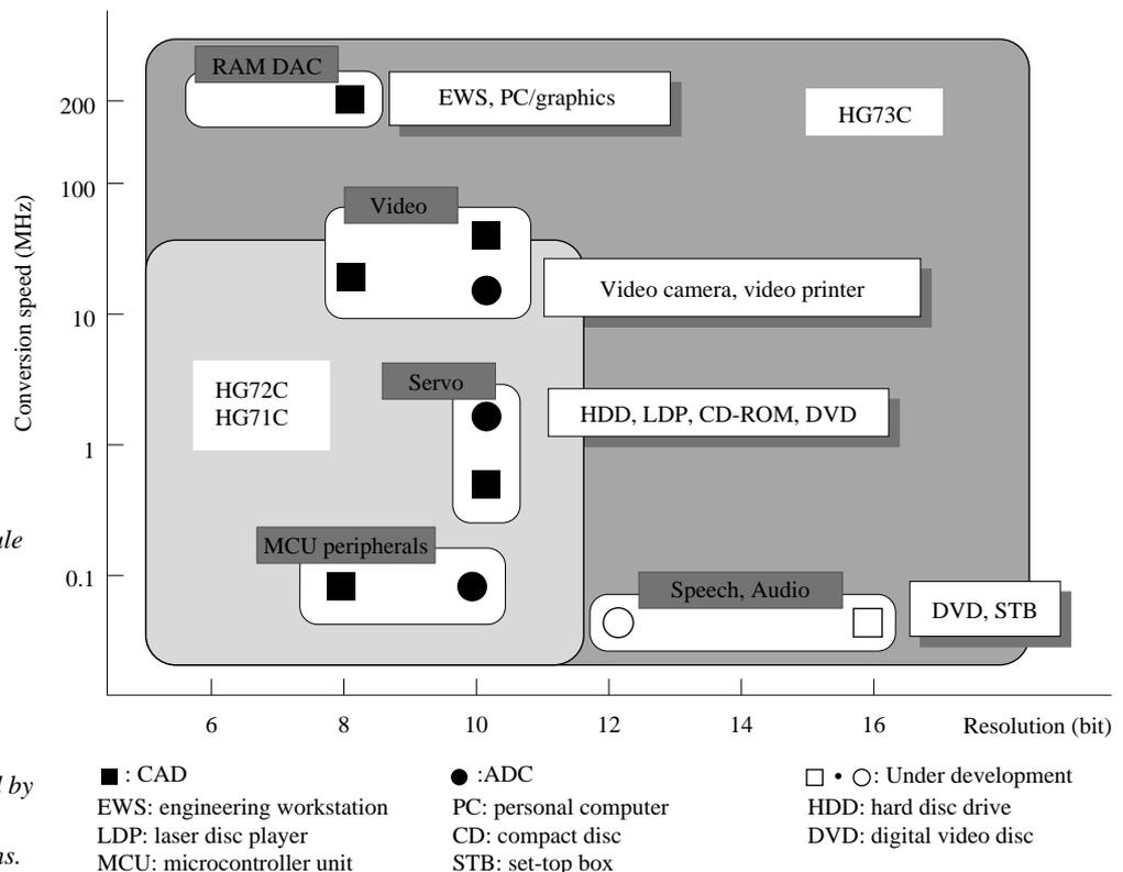
Fig. 3—μCBIC Analog Module Development.
